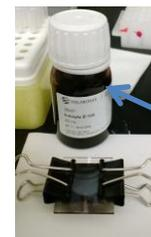
Añadir la solución de yoduro debe añadirse entre las diapositivas. El  $\text{TiO}_2$  teñido debe estar completamente saturado
